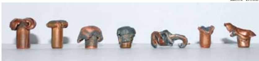
Ammutuista hirvistä löydettyjä laajenevia luoteja. Ensimmäinen vasemmalta on homogeeninen, lyijytön luoti (Barnes X). Seuraavat neljä ovat tavanomaisia, lyijypitoisia luoteja (Partizan Nova Grom, North Fork, Nosler Partition ja Swift Scirocco). Kaksi oikeapuoleisinta luotia ovat lyijypitoisia luoteja (Hornady Interlock), jotka ovat menettäneet vaipan kokonaan tai osittain.
